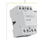
VS440 Số lượng tiếp điểm: 4x 40 A Cấu hình của tiếp điểm chuyển đổi và ngắt: 40, 31, 22, 04.
