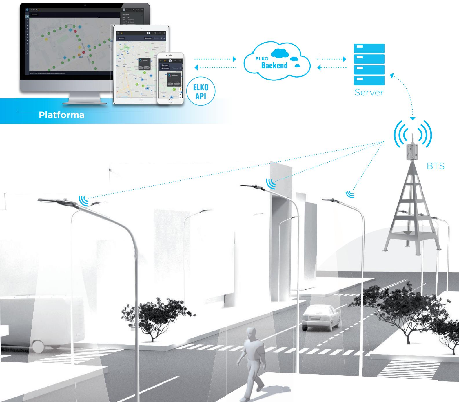
Hlavním prvkem infrastruktury je LoRA/NB-IoT LPWAN síť, která poskytuje konektivitu pro IoT zařízení ve Smart City.
